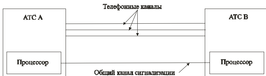
Рис. 8.9. Централизованная система сигнализации по общему каналу сигнализации
