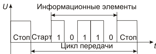
Рис. 2.7. Полная стартстопная комбинация пятиэлементного кода
